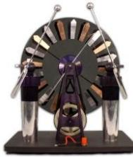
Рис. 19. Электростатический генератор
